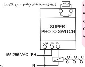
**توجه:** از وصل کردن مستقیم بارهای خازنی یا سونچینگ یا درایورهای LED به دستگاه به دلیل جریان بیش از حد راه اندازی در این نوع مصرف کننده ها، خودداری گردد. در این موارد الزاماً از رله خارجی یا کنتاکتور مناسب استفاده گردد.
