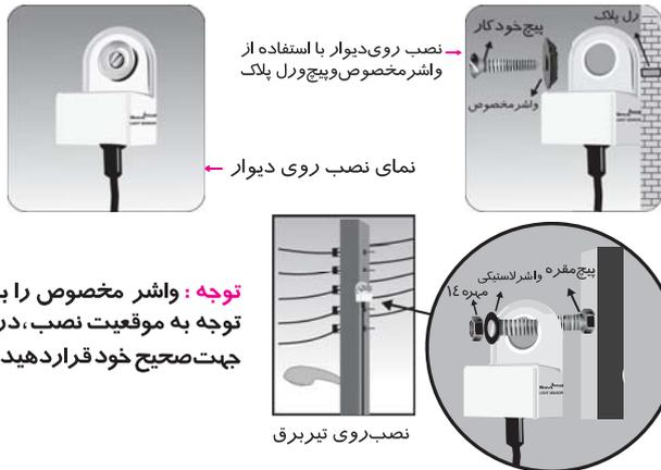
نصب روی دیوار با استفاده از واشر مخصوص و پیچ و رول پلاک
