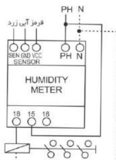
توجه: از وصل کردن مستقیم بارهای خازنی یا سوینچینگ یا درایورهای LED به دستگاه به دلیل جریان بیش از حد راه اندازی در این نوع مصرف کننده ها، خودداری گردد. در این موارد الزاماً از رله خارجی یا کاتکاتور مناسب استفاده گردد.
